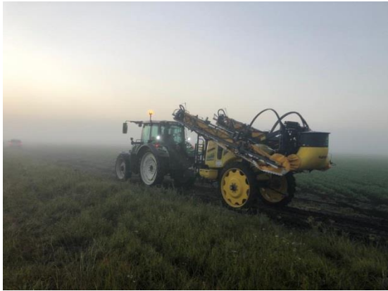
Εικόνα 5: Ψεκαστικό μηχανήμα για καλλιέργεια καρότου, με όλα τα συστήματα προσαρμοσμένα, σε πιλοτική δοκιμή στη Γαλλία
