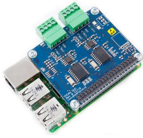
Εικόνα 2: Ο ελεγκτής Raspberry Pi προσαρμοσμένος για σύνδεση με δίκτυα ISOBUS
