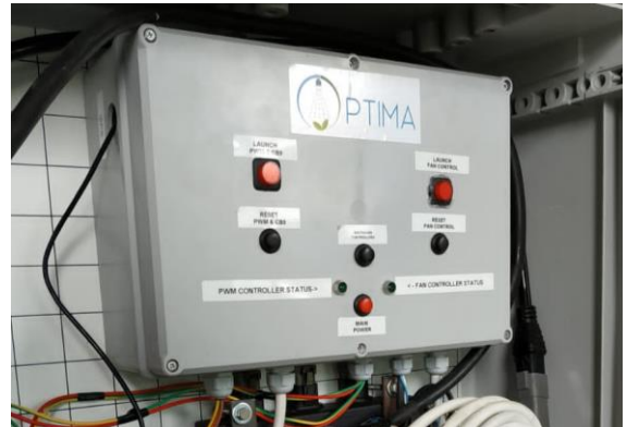
Εικόνα 3: Κουτί ελέγχου σχεδιασμένο στο ΓΠΑ για την προσαρμογή με τα ψεκαστικά μηχανήματα
